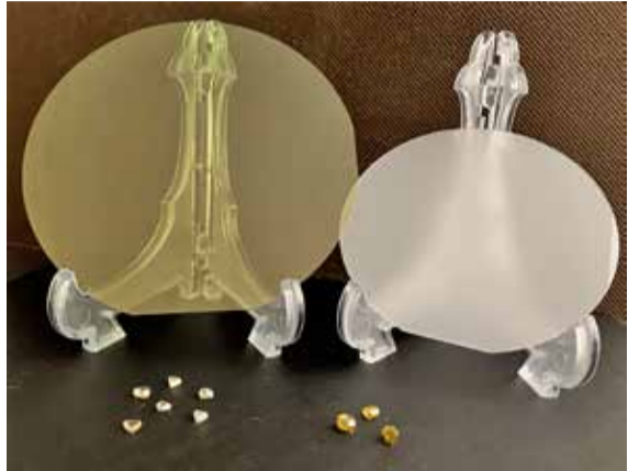
図1 各種結晶材料 (左上:SiC基板、右上:サファイア基板、下:ダイヤモンド)
