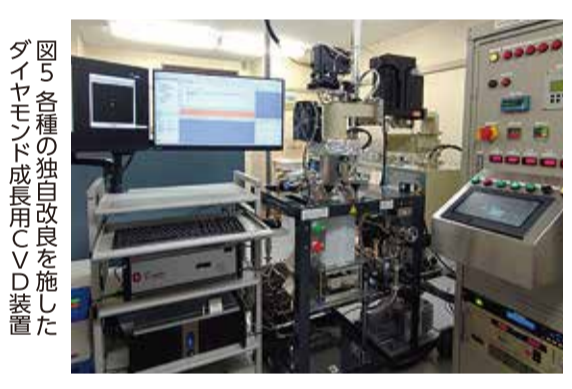
図5 各種の独自改良を施したダイヤモンド成長用CVD装置
