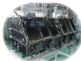
跳ね上げ式前面窓型 (防爆照明付)
